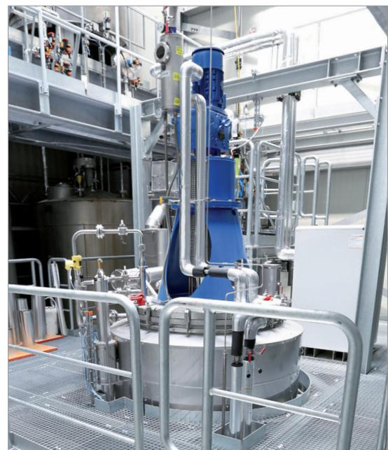
Nutriswiss verwendet eine Kurzwegdestillation, um Verunreinigungen in Fetten und Ölen effizient zu entfernen oder deutlich zu reduzieren.
